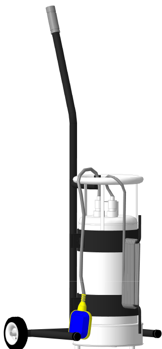
Рисунок Ж.5 – Тележка для транспортирования электронасоса типа ГНОМ 100-25
